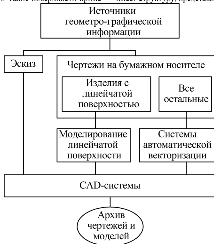
Рисунок 2 - Схема создания архивов электронных чертежей изделий сложной геометрической формы
