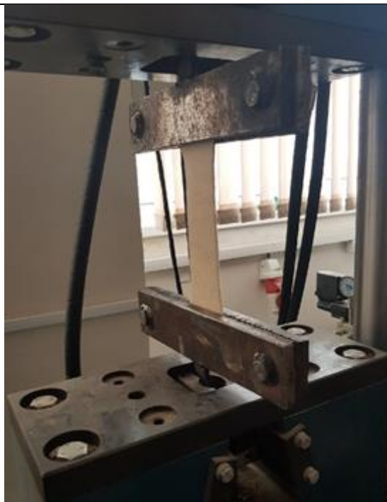
Рисунок 1. Определение прочности на растяжение и относительного удлинения при разрыве
