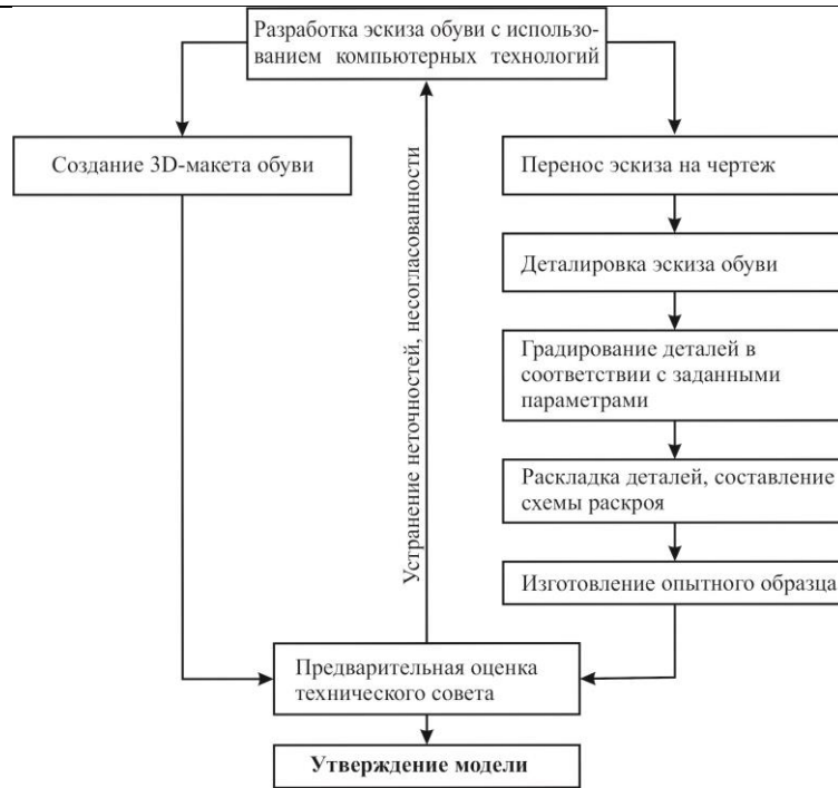
Рис. 13. Схема разработки эскиза обуви с использованием компьютерных технологий
