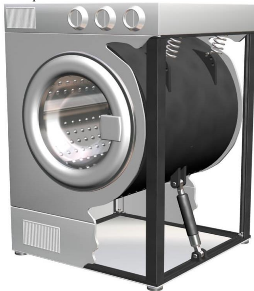
Рис. 2. Система виброизоляции стиральной машины с четырьмя упругими элементами и двумя демпферами
