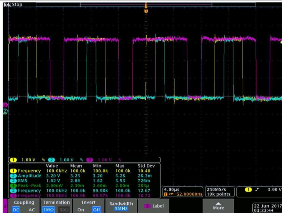
Рис. 10. ШИМ трёх верхних ключей
