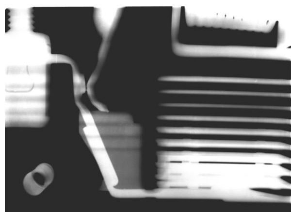
Рисунок 8 Рентгеновский снимок автоматического выключателя ВА 47-29 («Пардус»)
