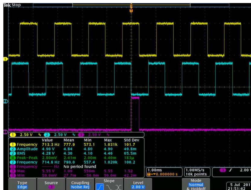
Рис. 7. Сигналы фазы A (желтый), B (синий) и индекса (красный)
