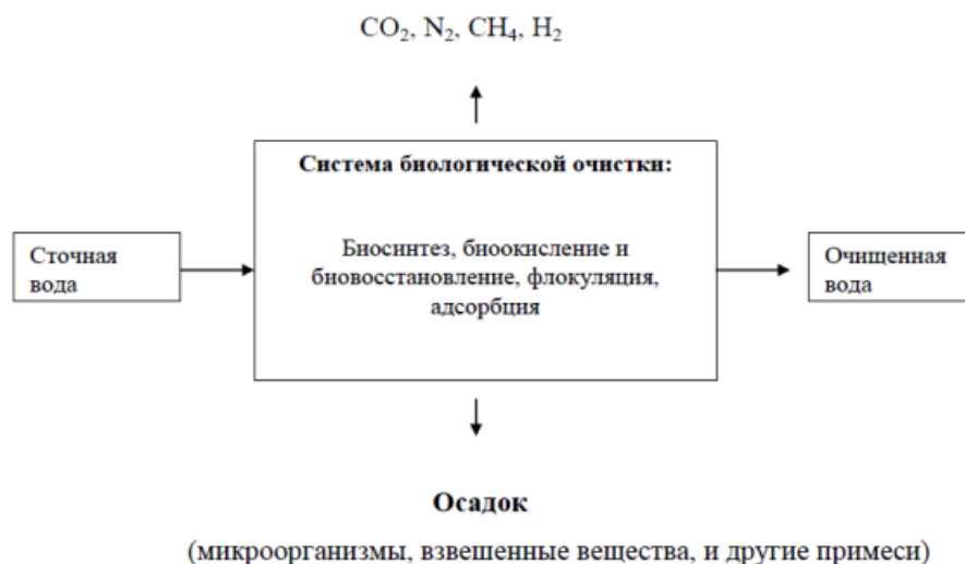
Рисунок 1. Схема биоочистки сточных вод
