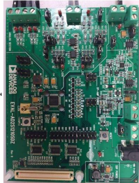
Рис. 6. Функциональная блок-схема AD2S1210 (слева) и отладочной платы (справа)
