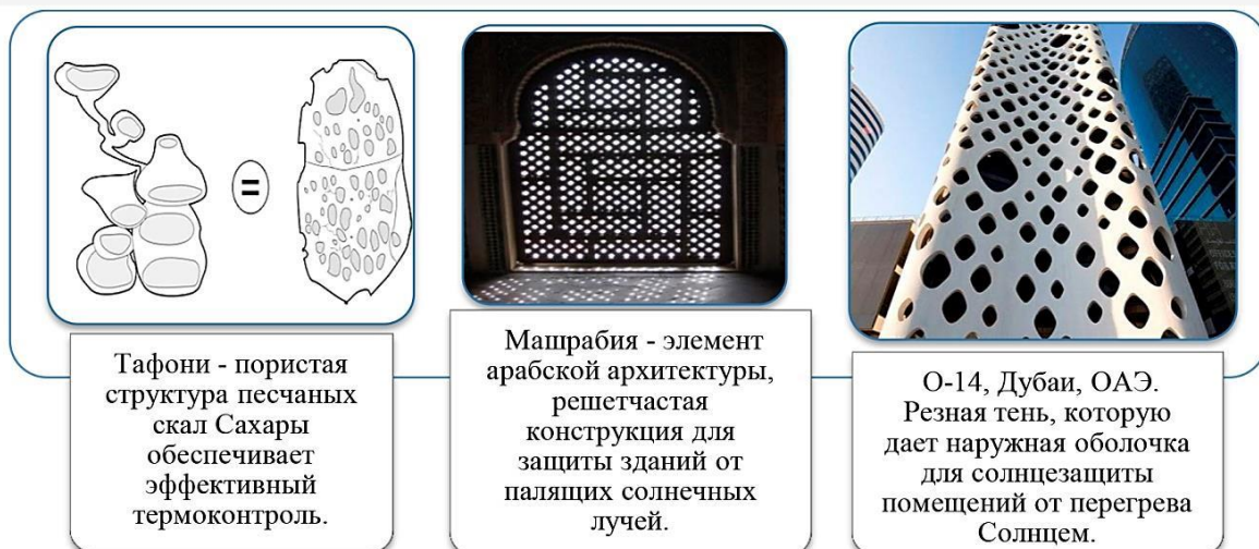
Рис.3. Анализ формирования аналогов процесса - солнцезащиты за счет использования конструкций и материалов.
