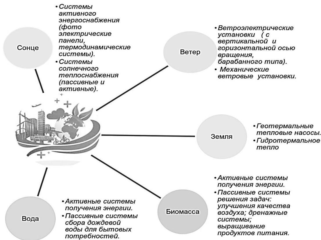
Рис.1. Информационная схема использования возобновляемых источников энергообеспечения в высотном биоклиматическом здании.
