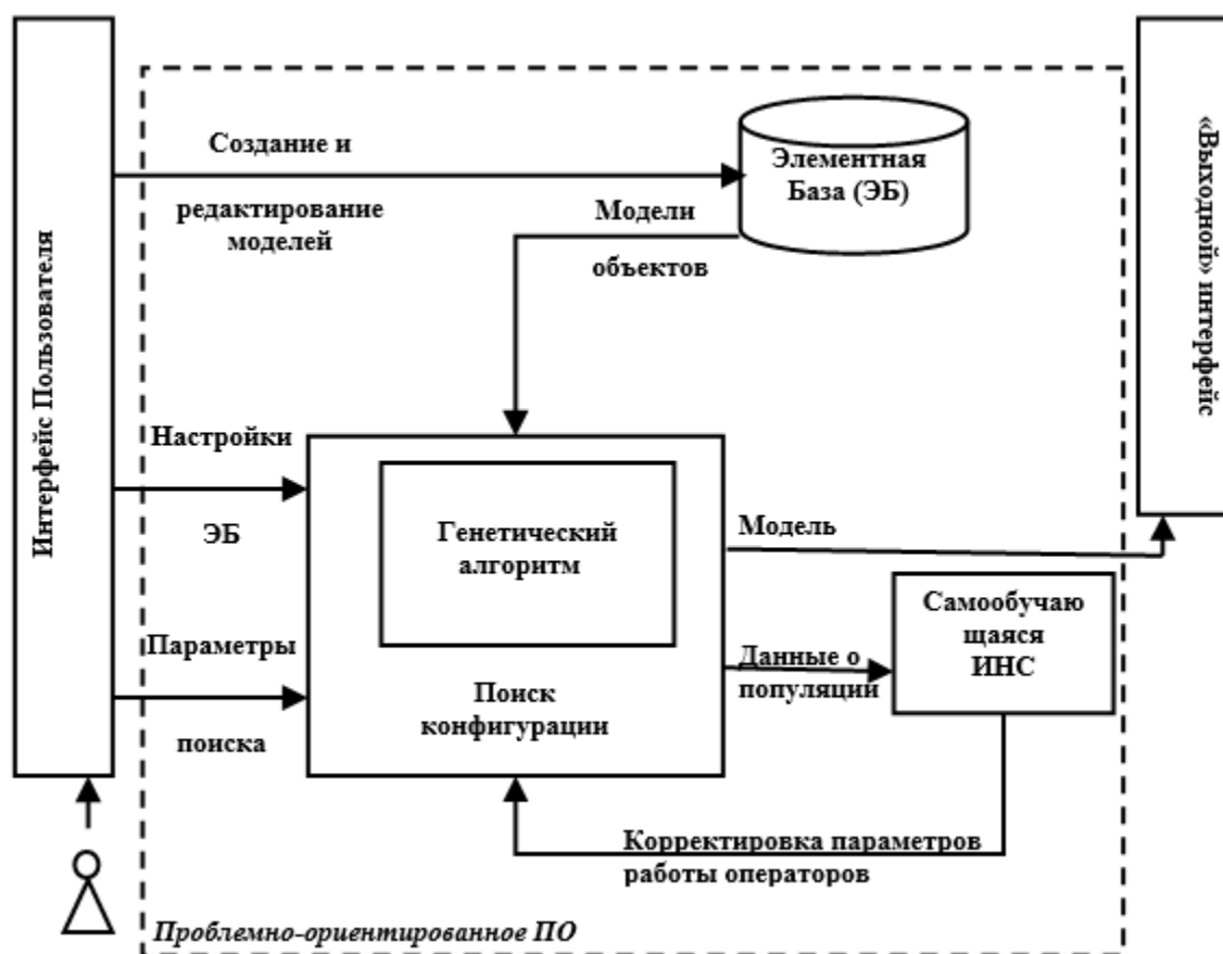
Рисунок 2 – Модель архитектуры интеллектуальной информационной системы с применением искусственной нейронной сети для управления генетическим алгоритмом
