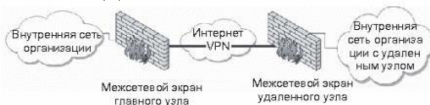
Сурет 2-Интернет арқылы өтетін VPN торапаралық байланысы
