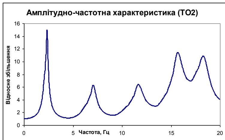
Рис. 4. АЧХ для T-складової коливаний поверхні моделі ґрунтової товщі інженерно-геологічного району № II (Ташлицька гребля), виділеного в межах території розміщення основних споруд Ташлицької ГАЕС, для випадку падіння поперечної хвилі знизу на підшову півпростору
