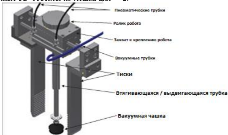
Рисунок 2 - Представление модели САПР разработанного захвата
