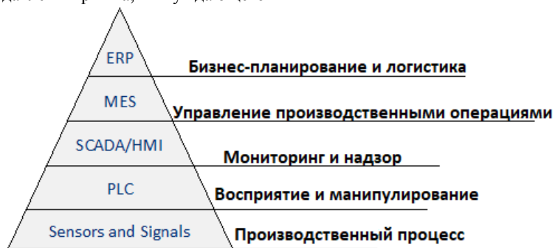
Рис. 1. Пирамида автоматизации в соответствии с ISA-95.
