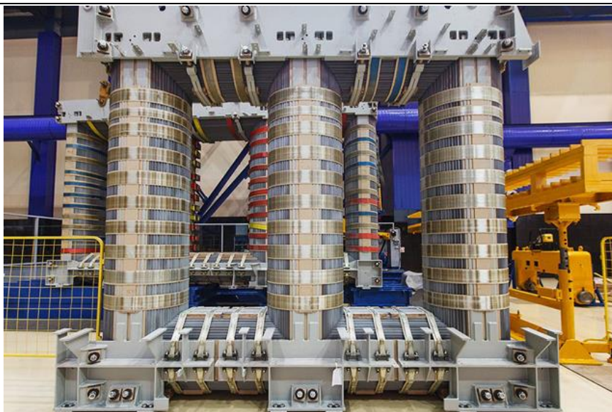
Рисунок 2 – Собранный магнит трансформатора
