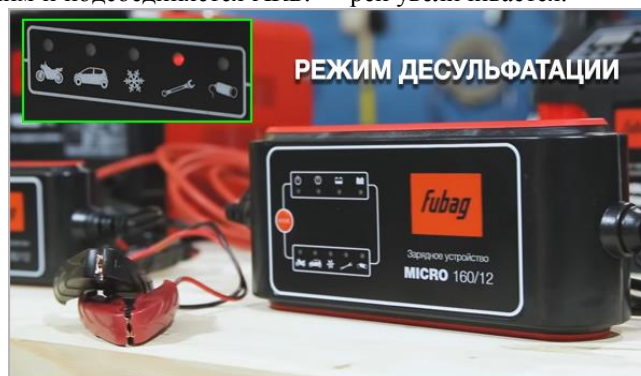
Рис.5. Зарядное устройство с режимом десульфатации
