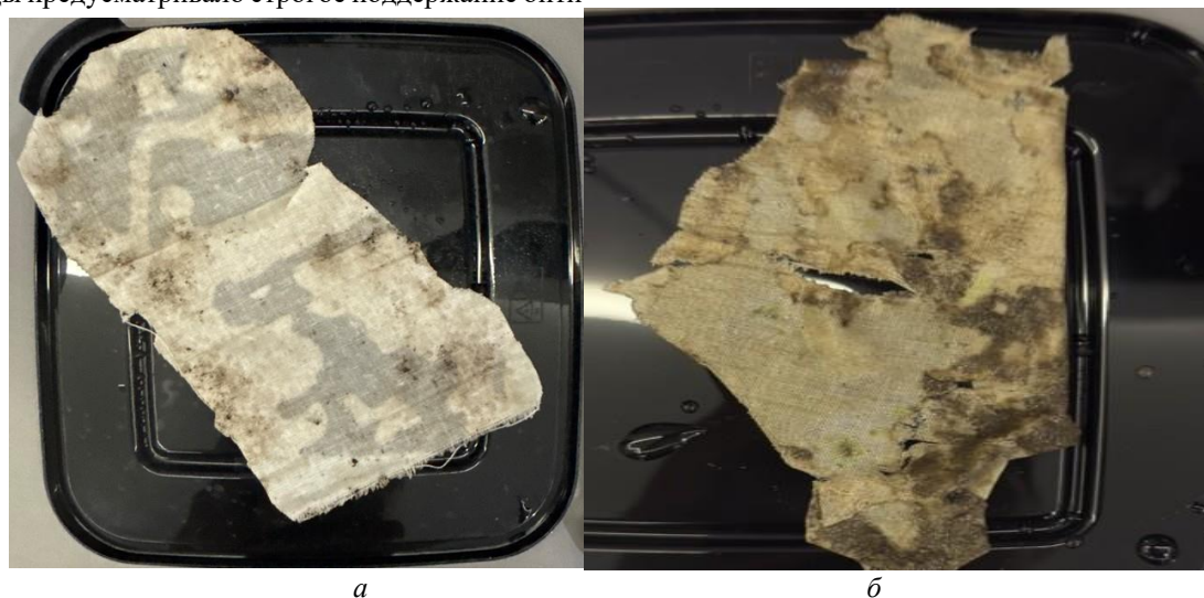
Рисунок 2 – Состояние целлюлозных тест-индикаторов после 30-суточной инкубации аппликационным методом Е.Н. Мишустина (а – сохранение структуры полотна в контроле; б – тотальная деструкция ткани в урбаноземе г. Аксай)
